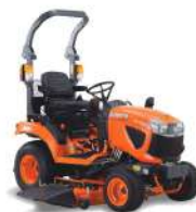
BX231 Motor: 22CV Transmisión: HST 2 Gamas
