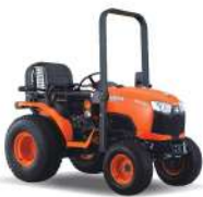
B2311 CAB/ARCO B2261, B2201 ARCO Motor: B2311: 29CV, B2261: 25CV, B2201: 20CV Transmisión: 9A/9R, HST 3 Gamas
