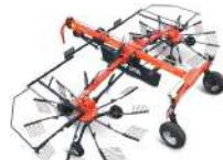
RA2076 Rastriño de doble rotor e hilerado central Anchura de trabajo: 7,00 - 7,80 m.
