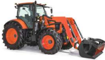
M6121 Motor (P. máx): 130CV Transmisión: 30A/15R
