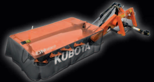
Kubota DM1017: 1,65 metros ancho de trabajo.
