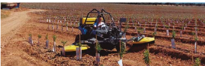
Pulverizador S-dome 900 con soporte eléctrico, en plantación joven de almendro 3.6 x 1.2m
