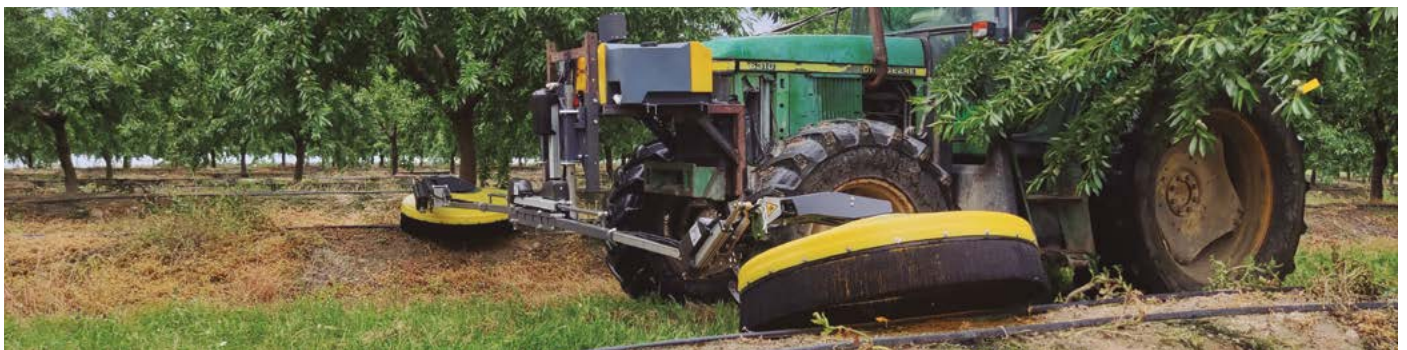
Pulverizador S-dome 900 con soporte eléctrico y depósito 60 L, almendro 6 x 6m
