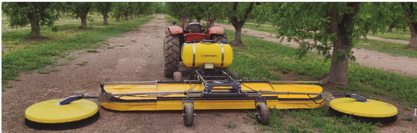
S-dome+ 3049 con campanas S-dome 1200 (7.2m de tratamiento), en nogal 12x12m
