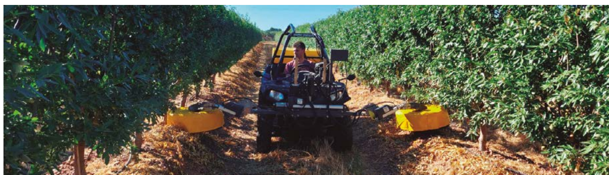
Pulverizador S-flex 600 con fundas, soporte eléctrico, almendro 3.6 x 1.2 m
