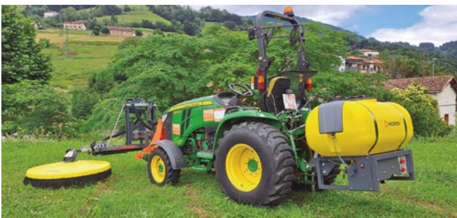
Pulverizador S-dome 1200, con soporte hidráulico (5-7m) y depósito 300L
