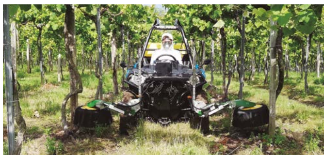
Pulverizador S-flex 400 con soporte manual, viñedo 2.3 m
