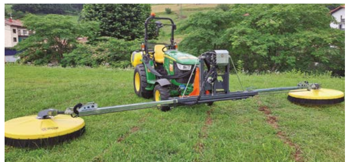
Pulverizador S-dome 1200, con soporte hidráulico (5-7m) y depósito 300L
