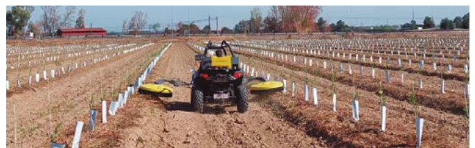
Pulverizador S-dome 900 con soporte eléctrico, en plantación joven de almendro 3.6 x 1.2m
