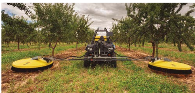
Soporte eléctrico, calles entre 3,2-6m
