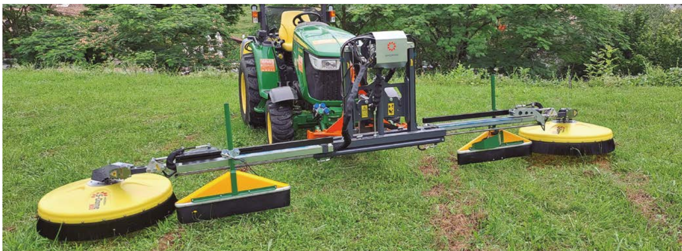
Soporte hidráulico con campanas S-dome 1200 y S-miser, para pulverizar calles de 7m con bandas de 2m.
