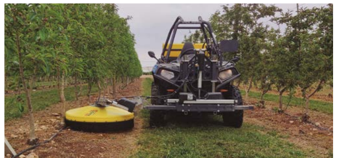
Pulverizador S-dome 900 soporte eléctrico en peral y melocotonero, 4 x 1.5m
