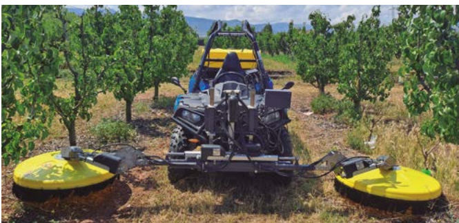
Pulverizador S-dome 900 soporte eléctrico en peral y melocotonero, 4 x 1.5m
