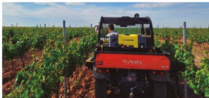
Pulverizador S-flex 400, con soporte manual, viñedo 2.6 m
